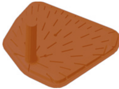
Filtergehäuse der Firma IBS-Filtran: CAD-Daten als Triangulierung im STL-vrml-view
